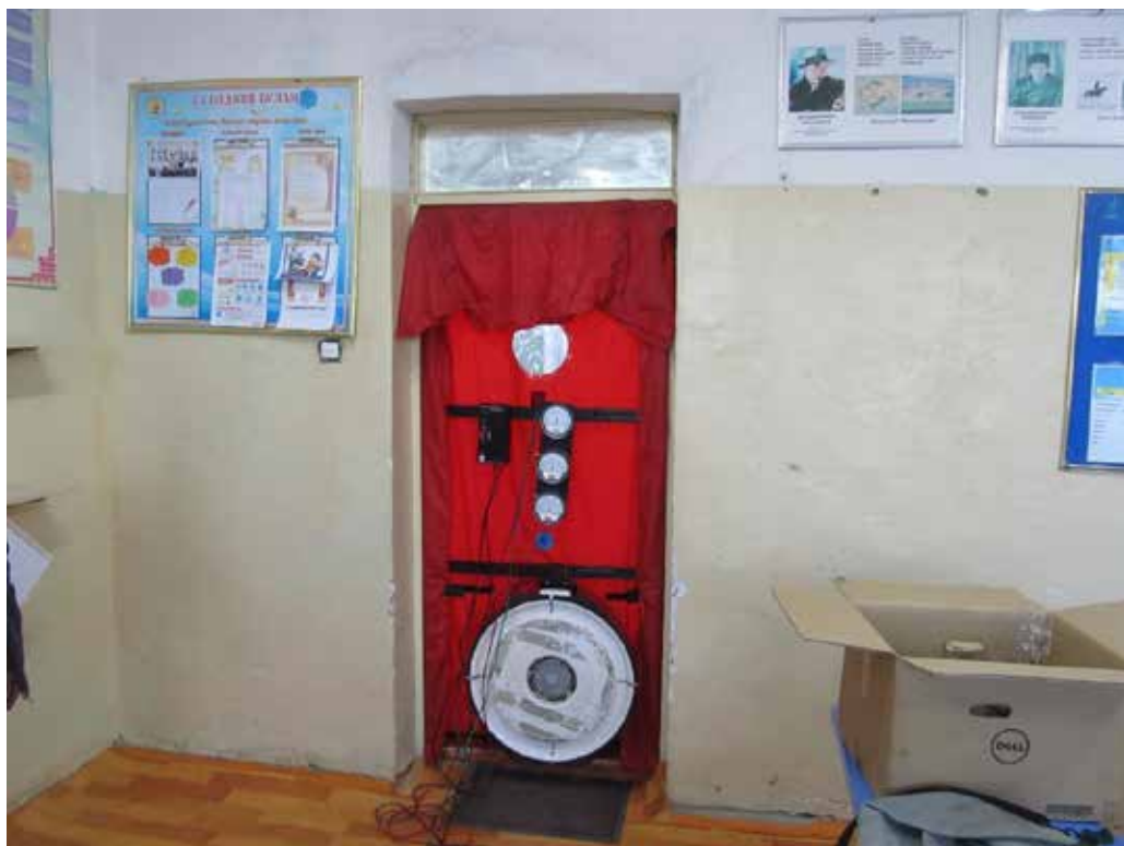
Зураг 5.1.4. Сүргүүлийн ангид “Blower door” багажаар барилгын /өрөөний/ агаар нэвтрүүлэлтийг хэмжилт хийж буй нь
